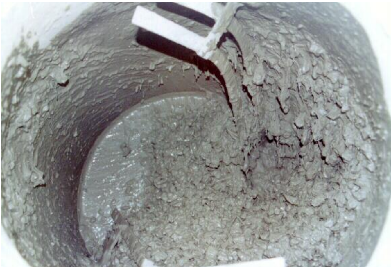
ASPECTO DO CONCRETO APÓS ADITIVO
